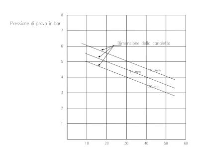
La prova deve essere effettuata non prima di un'ora dal termine dell'esecuzione del giunto. Prima dell'esecuzione della prova è necessario verificare la continuità della canaletta per il tratto in esame.
