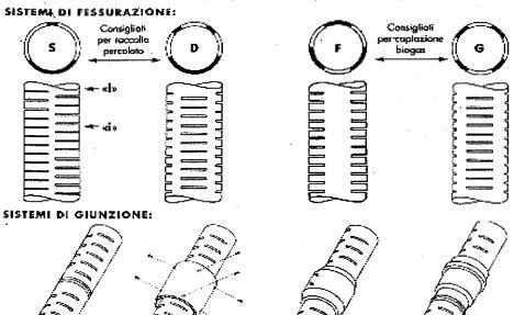
I tubi dovranno essere saldati seguendo le procedure indicate dalla norma UNI 10520, nel caso di saldatura di giunti testa a testa di tubi e/o raccordi, e quelle alla norma UNI 10521 nel caso di saldatura per elettrofusione
