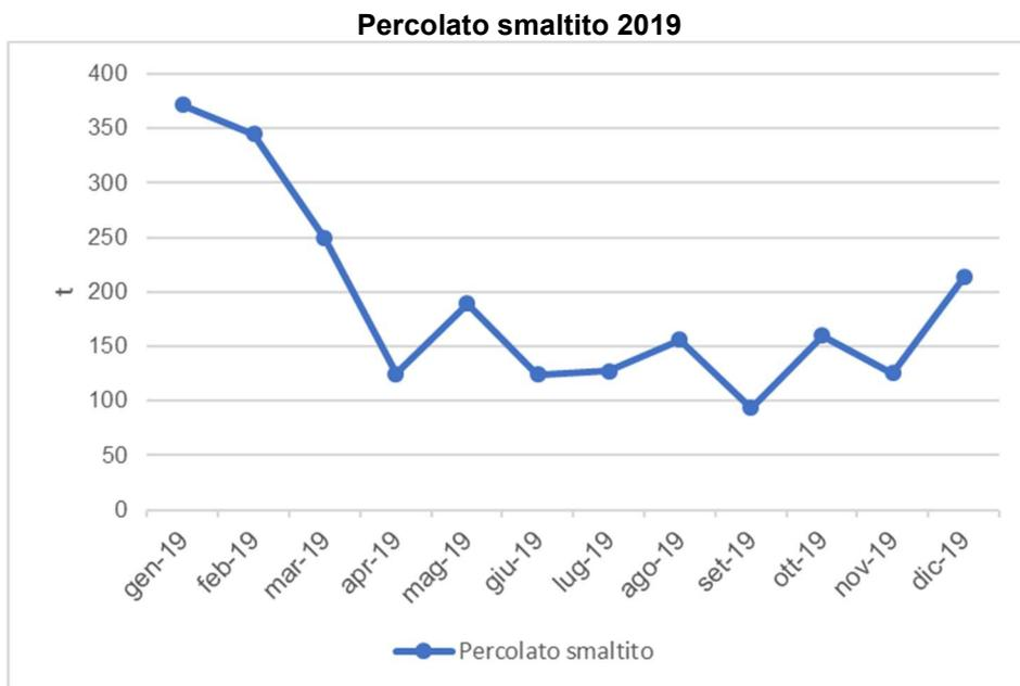
Il percolato estratto dalla discarica è stato correlato con le precipitazioni atmosferiche registrate dalla stazione meteorologica installata nell'area dell'impianto. Nel seguente grafico si riporta la produzione di percolato e le precipitazioni atmosferiche.
