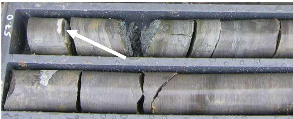
**Foto 2 – CPZ10, 45 m, frattura ricementata con calcite secondaria**
