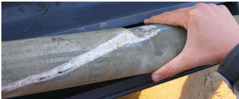
**Foto 3 – CPZ14, 28 m, piani di frattura con probabili ossidi di ferro e manganese**
