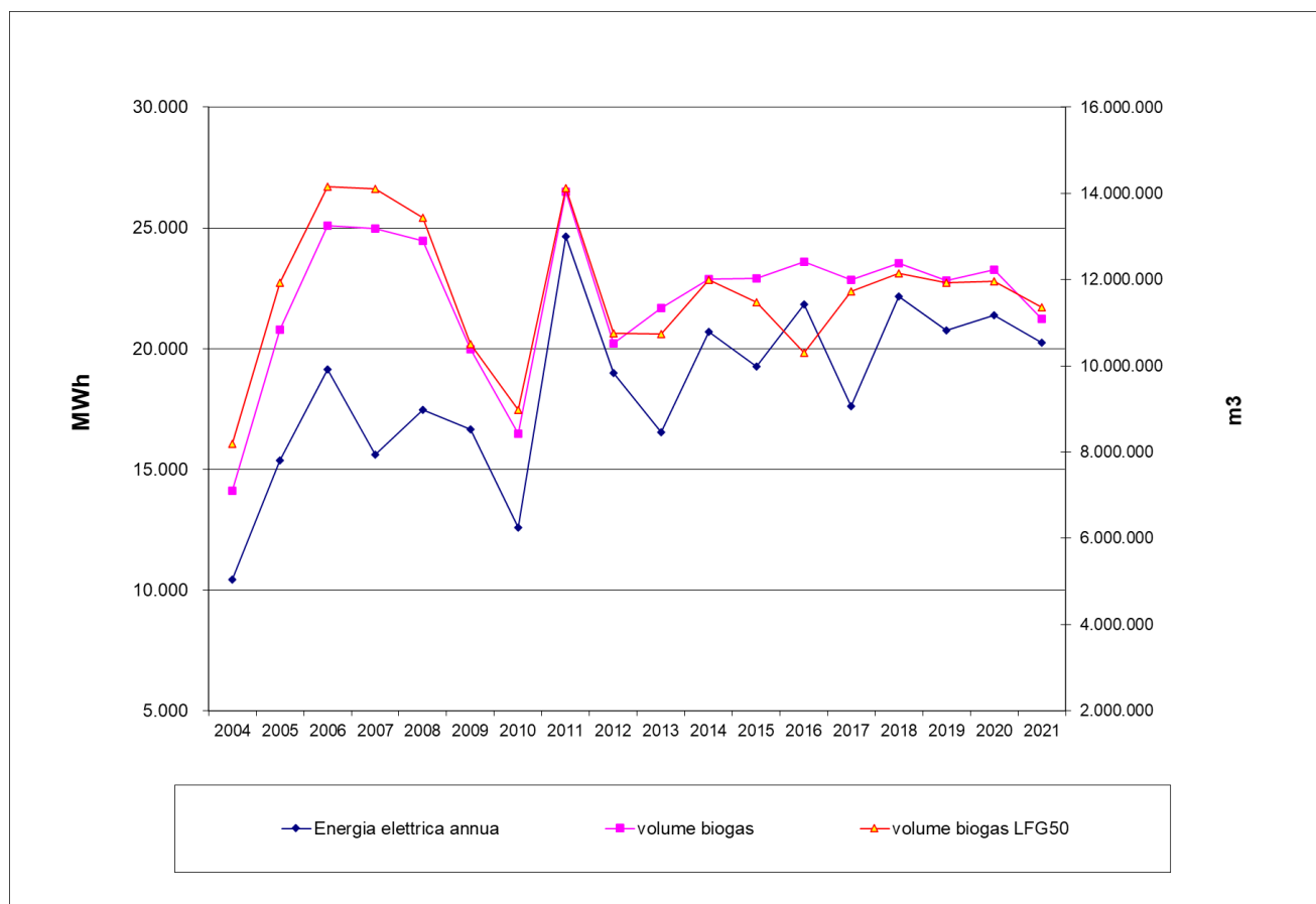
Figura 22 - Produzione annua di energia e biogas captato
