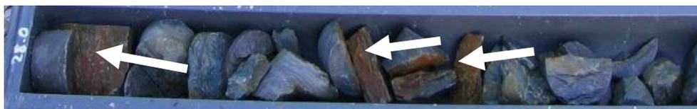
**Figura 11** - CPZ14, 28 m, piani di frattura con probabili ossidi di ferro e manganese
