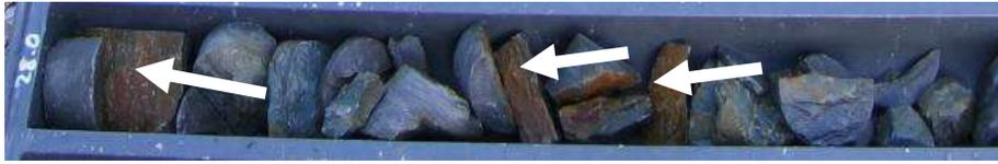
**Figura 11** - CPZ14, 28 m, piani di frattura con probabili ossidi di ferro e manganese
